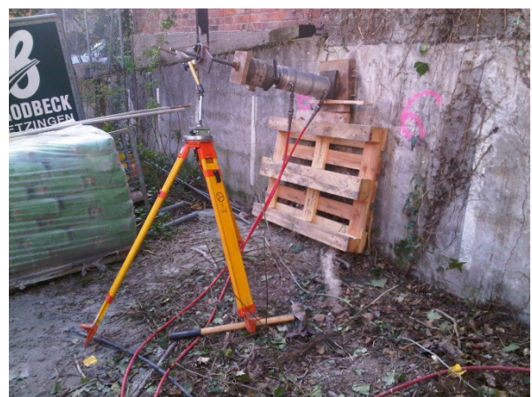
Foto 6: Versuchsaufbau Nagelausziehversuche Bereich Stützwand
