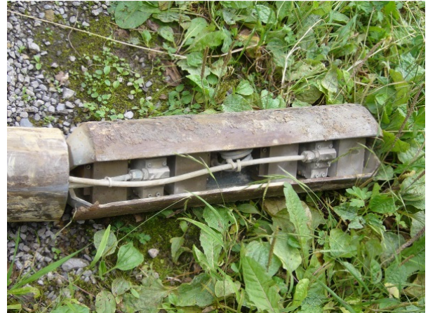
Foto 5: Lastschalen des Ettlinger Seitendruckgerätes (ESDS/146)
