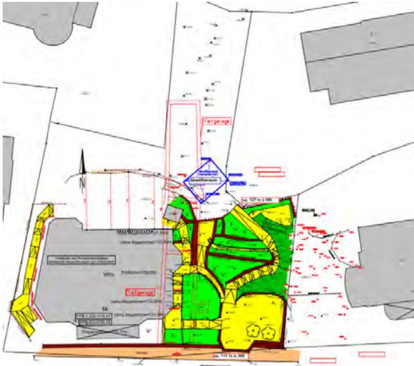
Die innerhalb des Baufelds vorhandenen **Natursteinmauern** sind denkmalgeschützt. Diese Natursteinmauern befinden sich am Kopf der für den Garagenneubau herzustellenden Baugrubensicherung im nördlichen Teil des Geländes. Der bauliche Zustand war insgesamt sanierungsbedürftig.
