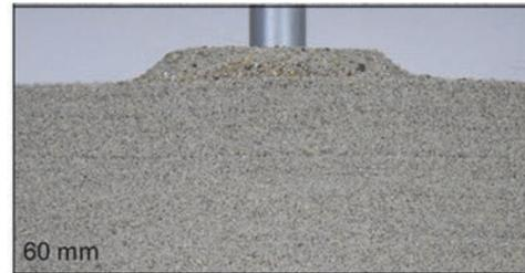
Abbildung 8: Aufwölbung während des Eindringprozesses der Versuche V224 und V323 [25]
